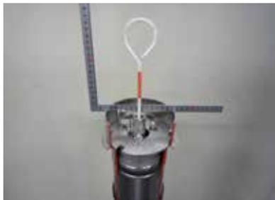
④ピンボールの挿入長を測定し初期値と比較して沈下量を判断する。
