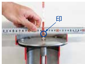
②調査棒を挿入し、印をつけ、沈下量を測定する。
