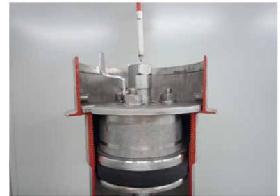
③開閉弁を貫通してピンボールを挿入する。
