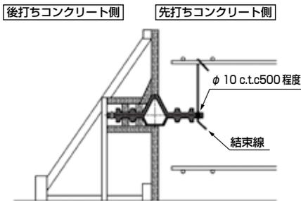
先打ちコンクリートの型枠組みに当たり、後打ちコンクリート側からBGパッキンを型枠材を用いて、壁厚の中心に位置するよう固定します。先行側は鉄筋を利用し番線で固定しますが、ゴムは引張らないよう注意して下さい。またゴムに直接釘打ちはしないで下さい。
