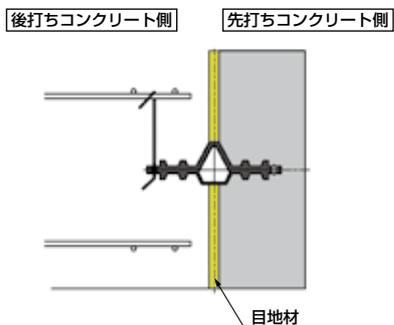
先打ちコンクリートを打設します。コンクリート養生後、型枠材を取り外し、先打ちコンクリート面に目地材を釘などを用いて固定します。先打ちコンクリートが控えて打設された場合不足分はモルタルや目地材で埋め、逆に増して打設された場合は増厚分を研って目地材を定位置に垂直に設けるようにして下さい。
