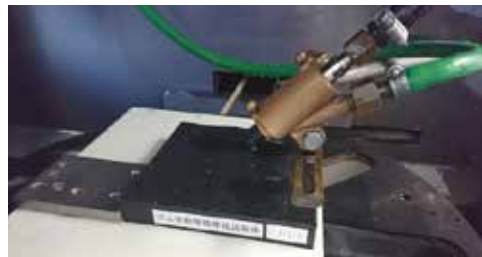
試験状況 (ウェットブラスト法)
